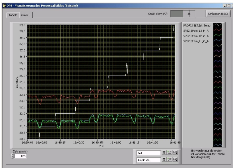
Bild 3: Visualisierung Prozessabbild (steigende Wassertemperatur, Ströme)
